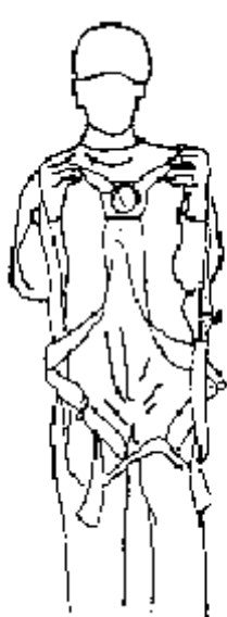
FIGURA 1: controllare che le cinghie non siano arrotolate
