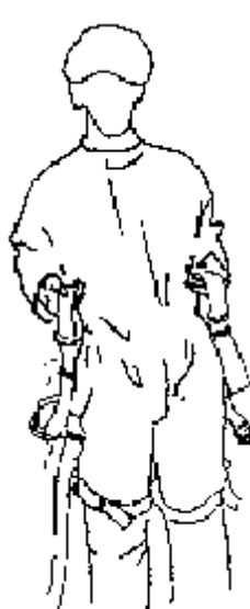
FIGURA 2: infilare l'imbracatura avendo cura di non attorcigliare il nastro ed assicurarsi di avere la placca arancione sulla schiena
