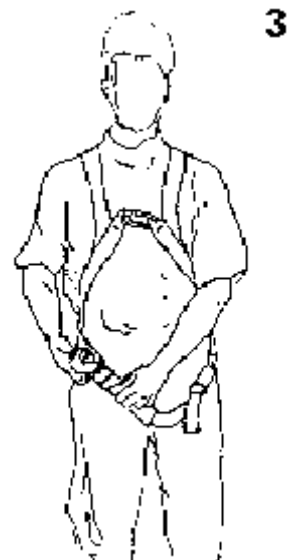
FIGURA 3: regolare la tensione dei nastri cosciali, tirando o rilasciando l'estremità libera del nastro. Fare attenzione a posizionare bene la placca dorsale a livello delle scapole.
